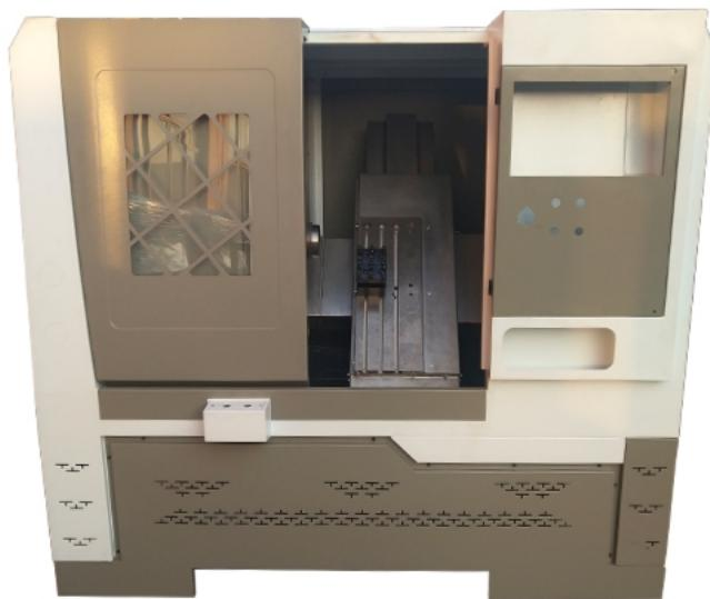
操作人员在使用数控机床前的准备工作和使用时应做好注意。工作前按规定穿戴好防护用品，扎好袖口，不准戴围巾、戴手套。女工发辫应挽在帽子内。高速切削时要戴好防护眼镜。认真检查机床上的防护、保险、机械传动部分、电气部分防护装置、卡盘是否安全可靠，电器开关和手柄是否在正常位置。按机床润滑图表加油，空转试车1—2分钟，查看油窗等部位。工夹、刀具及工件须装夹牢固，夹紧时可用接长套筒。卖仪器网禁止用榔头敲打。滑丝的卡爪不准使用，转换方刀架时应注意卡盘、工件与刀的距离。床头、小刀架、床面、滑道面禁止放工、量具或其它物品。加工细长工件要有顶针、跟刀架，车头前面伸出部分不得超过工件直径20倍。拉萨斜床身数控车床光机数控机床解决了复杂、精密、小批量零件的加工问题。
